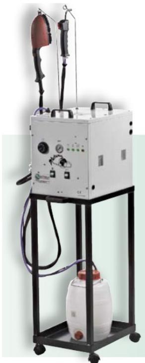
Бойлер из нержавеющей стали объем 6,2 л. Датчик давления, Давление 8 Бар. Догреватель пара, манометр, регулировка количества пара. С разъемом. Возможно подключение парового пистолета, паровой щетки и пр. аксессуаров. Назначение аппарата для обработки меха.
