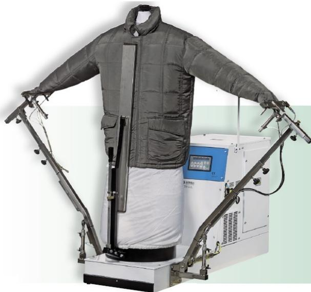
Универсальный пароманекен для верхней одежды с электронным управлением (16 программ), ручной регулировкой прижимных планок, в комплекте с растяжками и зажимами для рукавов. Пароманекен Battistella Zeus V оборудован четырьмя пневматическими прижимными планками (передней, задней и двумя боковыми) и устройством автоматической растяжки. Данная модель имеет вращающуюся конструкцию, которая может регулироваться по высоте с помощью пневматического привода.
