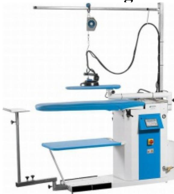
Гладильный стол среднего размера с гладильной поверхностью 1200\*400 мм, профессиональный. Оснащена функциями нагрева и вакуума, оборудована бойлером из нержавеющей стали, электронным управлением, электропаровым утюгом и двумя педалями управления.
